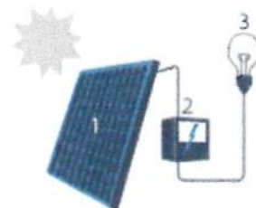
1 Zonnepaneel | 2 Omvormer | 3 Elektrische installatie
